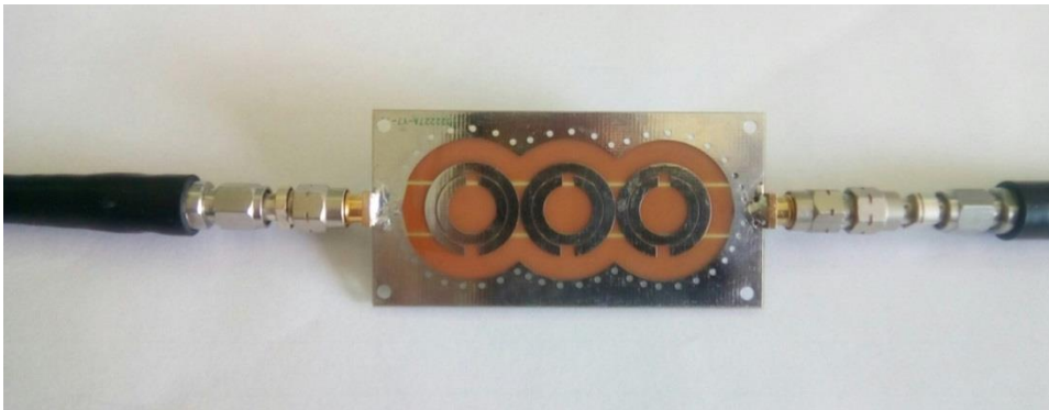
Рис. 4. Печатная плата режекторного фильтра, подключенного к измерительному оборудованию
