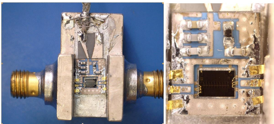
Рис. 3. Внешний вид изготовленного МОИС МШУ в LTCC исполнении в устройстве подключения (справа – увеличенное изображение МОИС МШУ)
