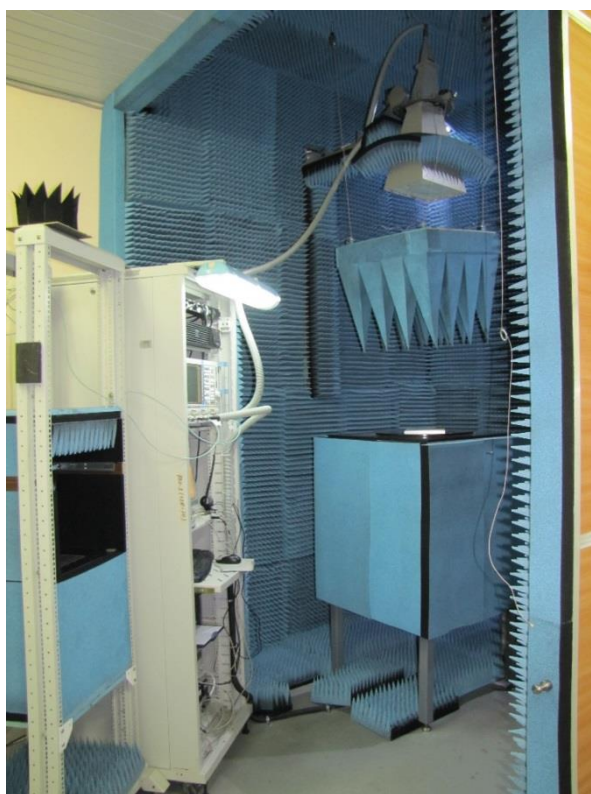
Рис. 4. Стационарный стенд для измерения радиотехнических параметров образцов материалов и покрытий
