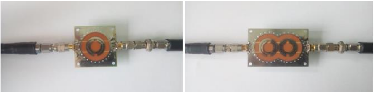
Рис. 3. Печатные платы с топологией на основе двойных кольцевых резонаторов: а) базовый элемент – двойной кольцевой разрезной резонатор; б) печатная плата режекторного фильтра на основе двух кольцевых резонаторов
